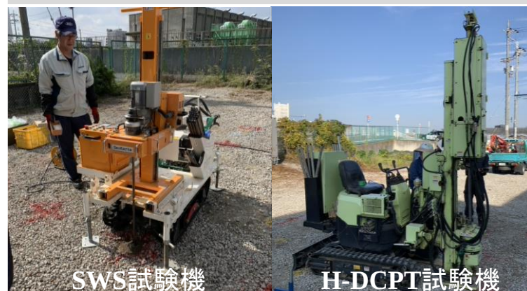
図-4 宅地の地盤調査試験機の開発
