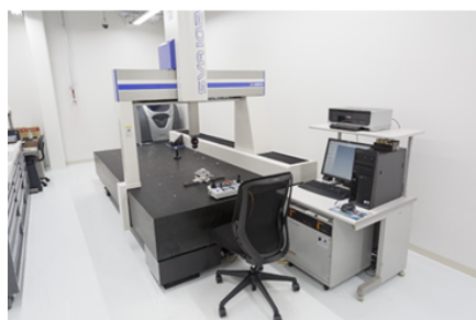
写真 8-1 検査ブース 3 次元測定器 【工程】⑦
