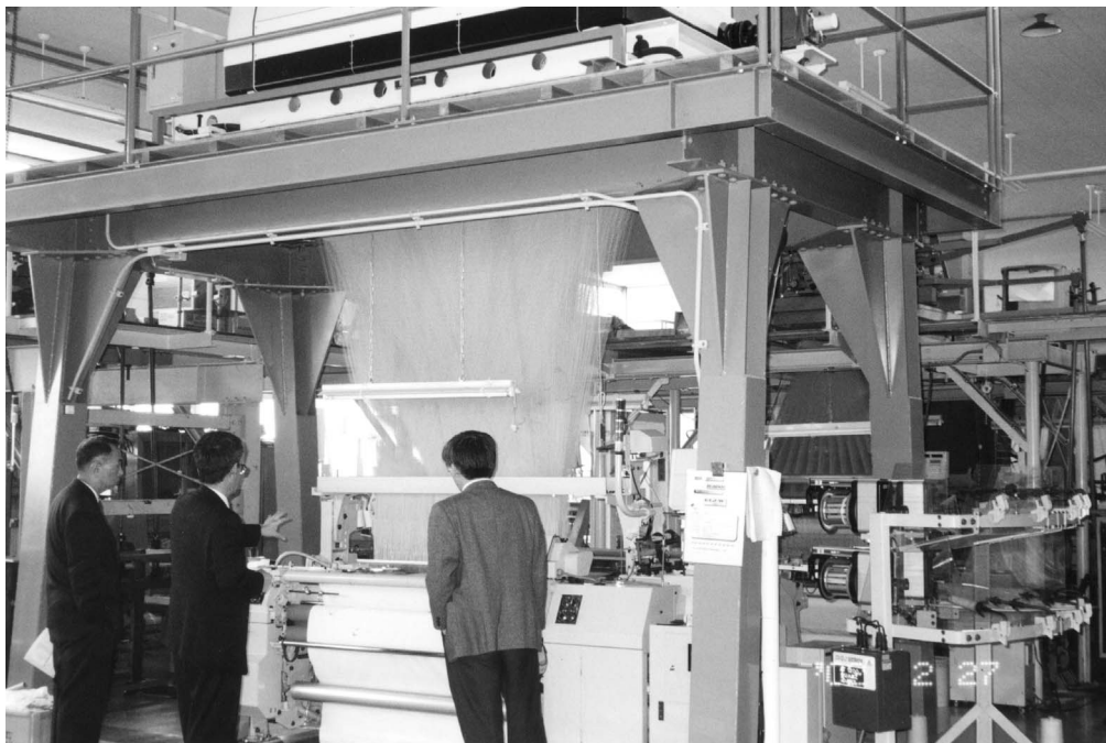
写真V-5 京都府振興センターで稼働している最新鋭のレピア織機 (津田駒工業製) R300; 電子ジャカード (カヤバ工業製) ELJ-W (4032) (庄谷撮影)
